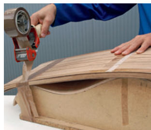
... und das Furnierpaket auf der Schablone mit Klebeband fixiert
