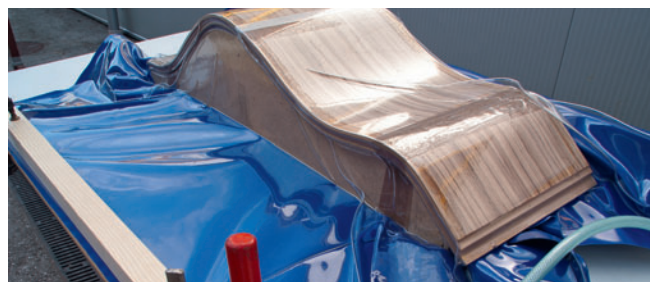
Das Vakuum sorgt für eine allseitig gleichmäßige Verpressung
