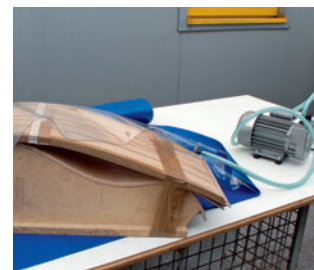
Der Kunststoff sack wird verschlossen und die Luft abgesaugt
