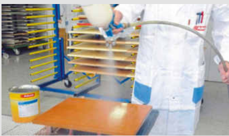
/ Für einen transparenten Aufbau werden feinporige Hölzer zwei- oder dreimal gefüllt, grobporige öfters.
