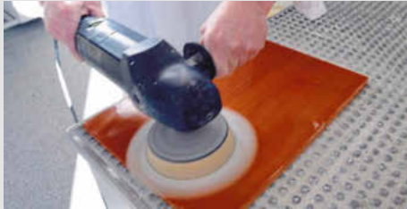
/ ... dann wird mit grober Schleifpaste und Lammfell poliert, danach mit feiner Paste und Schaumstoffscheibe.
