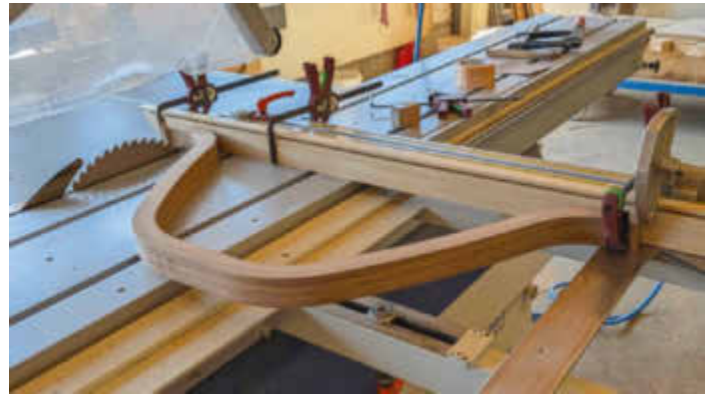
/ Effizienter Standardmaschineneinsatz: Das exakte Ablängen der beiden Enden der exakt auf Breite formatierten Arme erfolgt auf „Riss“ auf der Formatkreissäge.
