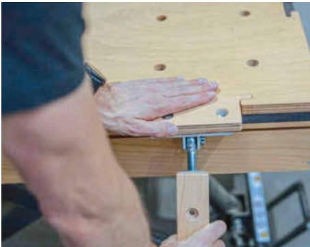
/ Die drehbaren Arme rasten wie Puzzlestücke ein, orientiert an der Konstruktion der Werkstattwagen.
