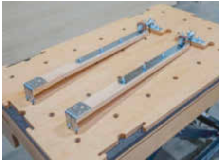
/ An den Enden der Arme greifen Winkelhaken die Platte an der Unterseite. Die Armlänge lässt sich über die ...
