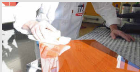
/ Das Auspolieren als Finish erfolgt von Hand. Bis es soweit ist, sind oft mehrere Tage vergangen.
