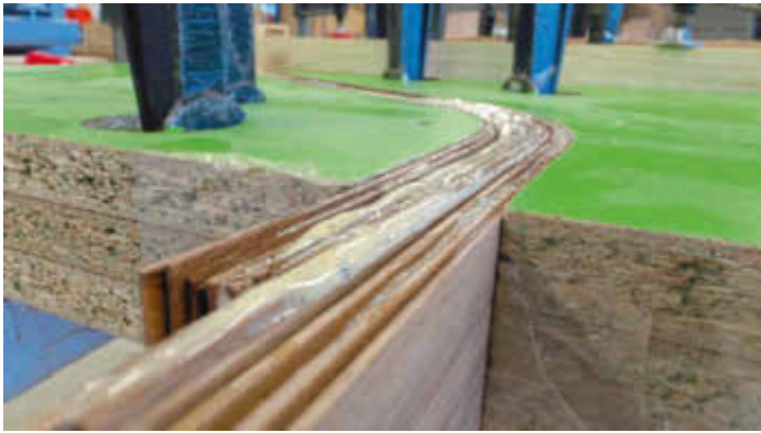
/ Aus gut dreißig Schichten 1 mm starkem, amerikanischem Nussbaumfurnier setzen sich die in einem Stück verleimten Arme der Stummen Dienerin zusammen.
