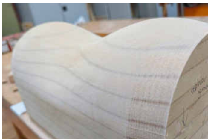
/ ... das sie im Vakuumsack über einer auf der CNC hergestellten Positivform unter Nutzung von 2K-Klebern verklebte.
