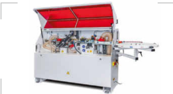
/ Zu den Highlights der Kantenanleimmaschine zählt das patentierte HF-Multifunktionsfräsaggregat.
