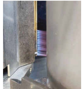
/ Gezielter Einsatz der charakteristisch bläulichen Flamme durch Düsen.
