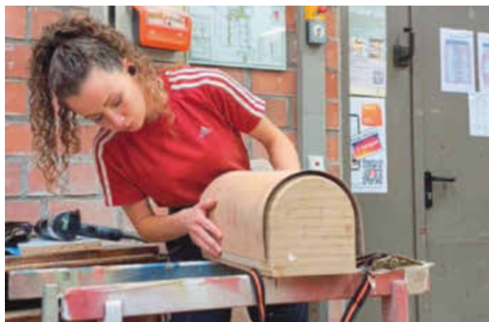
/ Nutzung moderner Techniken: Für die Herstellung der plastisch geformten Türen ihres Meisterstückes nutzte Johanna Haas spezielles 3D-Furnier der Firma Danzer, ...
