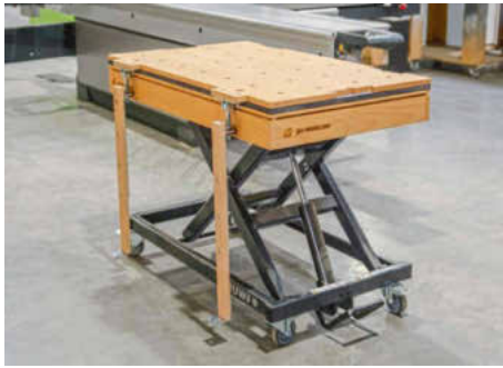
/ Ausgangspunkt ist ein handelsübliches Hubgestell, auf dem eine einfache, clevere Konstruktion montiert wird.
