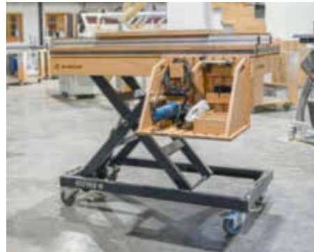
/ Der Wagen dient auch als Werkbank mit eingehängtem Werkzeugmodul und Auflageschienen für Teile.
