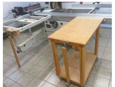
/ In kleinen Werkstätten ermöglicht eine kompakte Lösung an der Säge das Kippen und Ablegen der Platte.
