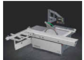
/ Flexibel und vielseitig konfigurierbar: Formatkreissäge F35.
