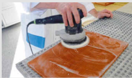
/ Wenn es wirklich perfekt sein soll, kommt man um das Polieren nicht herum. Zuerst erfolgt der Nassschliff ...
