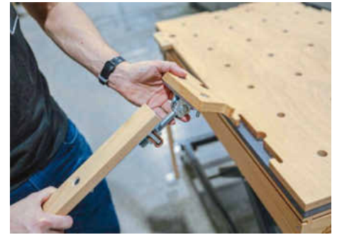
/ ... Lochreihe an unterschiedliche Plattenhöhen anpassen. Die Arme sind über Torbänder drehbar gelagert.
