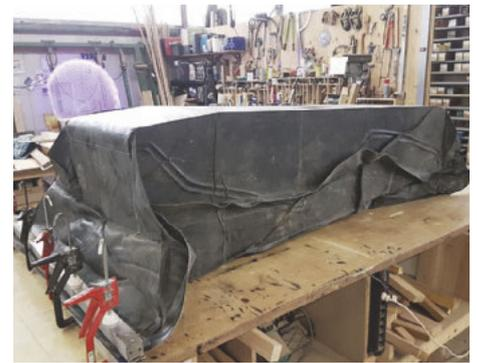
**3/** Wurde das Deckmaterial zuvor formatiert, kann beim Pressen in der Vakuumasche nichts verrutschen. Es dauert ca. acht Stunden, bis das Epoxidharz ausgehärtet ist und die Liege aus der Form genommen werden kann.
