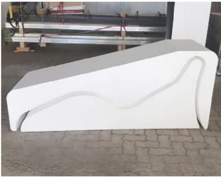
**1/** Zu Beginn der Liegenfertigung braucht man Negativschablonen aus Styropor. Sie werden auf der 5-Achs-CNC passgenau gefräst und auf den Innenseiten mit glasfaserverstärktem Kunststoff belegt.
