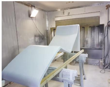
**5/** Erhältlich sind die Pureworkz-Liegen auch in Betonoptik. Der Rollbeton wird genau wie Furnier verarbeitet und zum Schluss ebenfalls klar lackiert.
