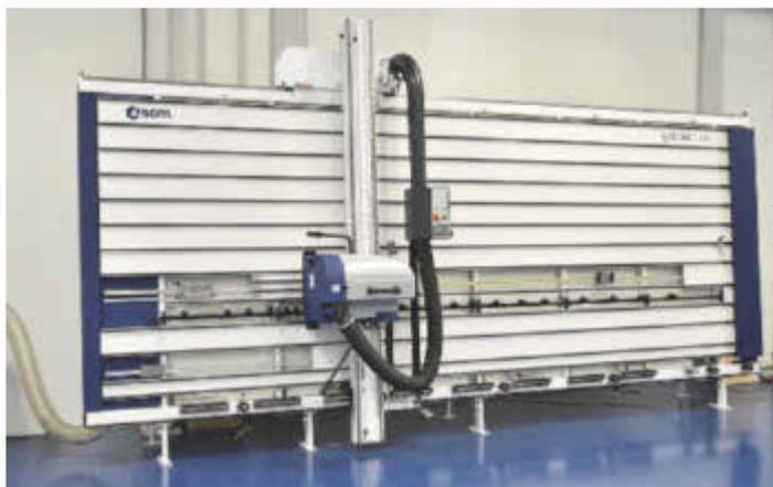
/ Die vertikalen Plattensägen „Gabbiani“ können für den Schnitt unterschiedlicher Werkstoffe aus Sperrholz, Laminat und Massivholz eingesetzt werden.
