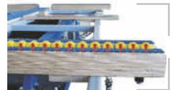
/ Die Röllchenleisten sind quer zu den klappbaren Flügeln angeordnet.
