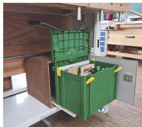
/ Jeder hat seine eigene Hobelbank inkl. abschließbarem Korpus, der Platz für exakt einen sog. Tooltainer bietet. Hier wird sämtliches Handwerkzeug verstaut.
