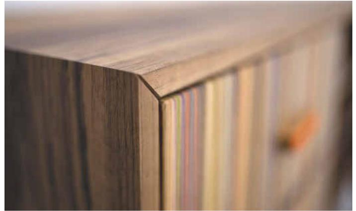
*/ Der Korpus des Musikmöbels aus massivem, amerikanischem Nussbaum ist stumpf auf Gehrung verleimt und die Fuge durch eine V-förmige Kerbe betont.*
