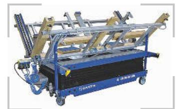
/ Eine Hydraulik mit Akku-Antriebsaggregat sorgt für die Wendefunktion.
