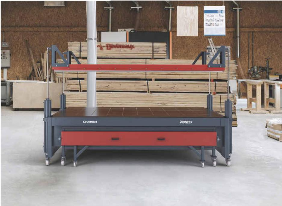
*/ Laut Columbus ist Pioneer das weltweit erste patentierte Vakuumpressen-Modulsystem, hier zu sehen in der Vollausbaustufe mit den Modulen Heat (Heizlade) und Vertical (vertikaler Öffnungsmechanismus).*
