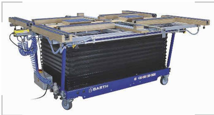
/ Mit der Wendefunktion des Wendolift RL können Werkstücke bis zu einem Gewicht von 140 kg und 130 cm Breite problemlos gewendet werden.
