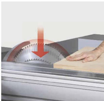
PCS® – die revolutionäre Weltneuheit bei Sicherheitseinrichtungen für Formatkreissägen: Unfallgefahr gebannt, auf Knopfdruck wieder einsatzbereit.
