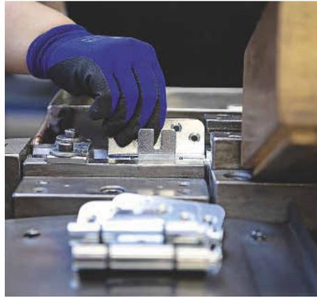
*/ Aller Automatisierung zum Trotz gehört zur Beschlagfertigung immer noch einiges an Handarbeit.*
