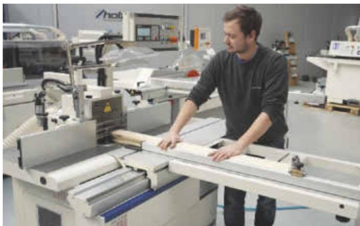
*/ Mit der Tischfräsmaschine Minimax twf 55 es M 3 UP von Holzskraft können individuelle Kundenwünsche präzise, zeitnah und flexibel umgesetzt werden.*
