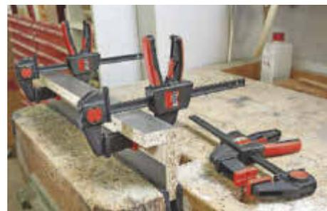
*/ Robust: Ober- und Unterteile der EZR-Einhand-Tischzwinde sind aus glasfaserverstärktem Polyamid.*
