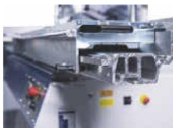
/ Der neue Rollwagen ist besonders für die Massivholzbearbeitung geeignet.
