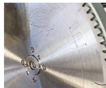
/ Kappsägeblatt mit der innovativen Sägeblattbohrung „easyFix“.
