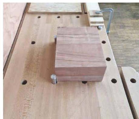
/ Mehrere Bohrungen in der Tischfläche sorgen für Flexibilität beim Einsatz von Bankhaken.
