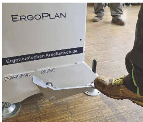
/ Der Ergoplan EP 1 von Beck lässt sich per Fußhydraulik stufenlos von 780 bis 1080 mm in der Höhe verstellen.
