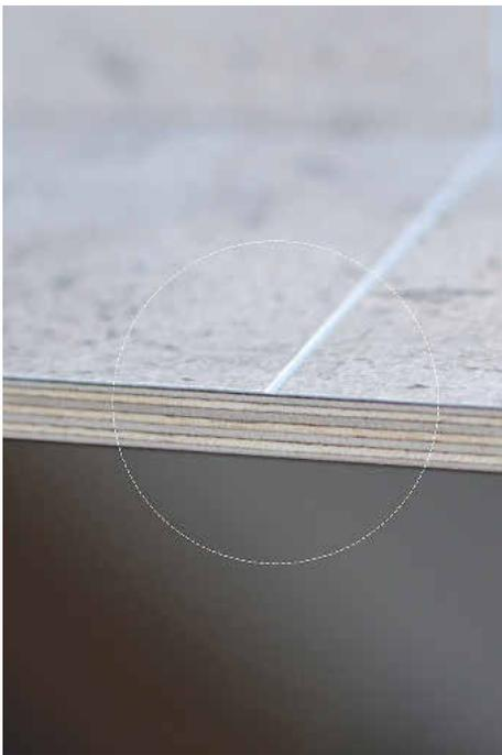
/ Querschnitt einer Fibo-Wandpaneel mit Multiplexkern aus Birkenperrholz.
