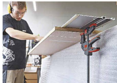
*/ Praktisch: Die EZR-Einhand-Tischzwinde ermöglicht eine ebenso ergonomische wie sichere Handhabung.*
