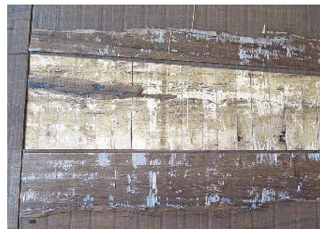
/ Fehlverleimungen zwischen der Räuhereichendecklage und Fichtenmittelschicht.
