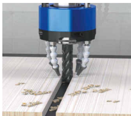
Das Blasdüsenaggregat formatiert und reinigt in einem Schritt
