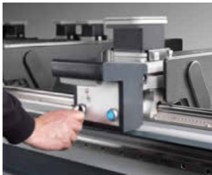
Konsolenfreischaltung – Durch die einzeln deaktivierbaren Konsolen können Abfallteile entnommen werden, ohne die Fixierung des Werkstückes aufzuheben.
