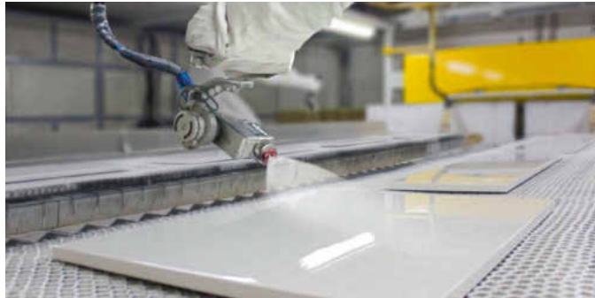
Automatische Nasslackapplikation für Holzwerkstücke
