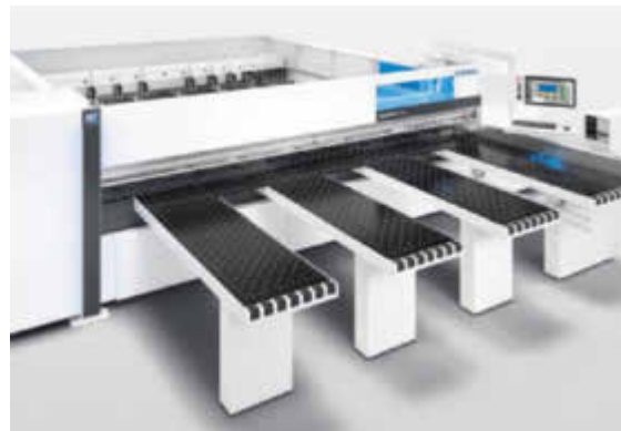
Die Neupositionierung der Sawteq B-300/B-400 erfasst und überwacht die Maßhaltigkeit der Werkstücke
