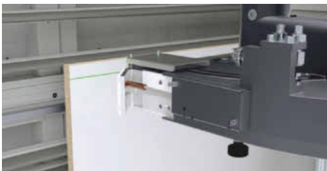
Linienlaser für Besäumschnitte auf der vertikalen Sector-Säge
