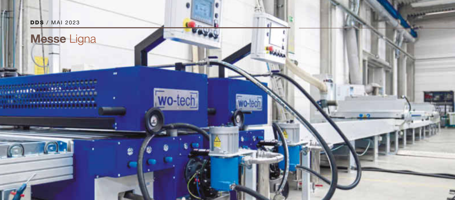
Robuste Technik: Walzenauftragsmaschine für flexible Anlagenkonfiguration und vibrationsfreies Lackieren
