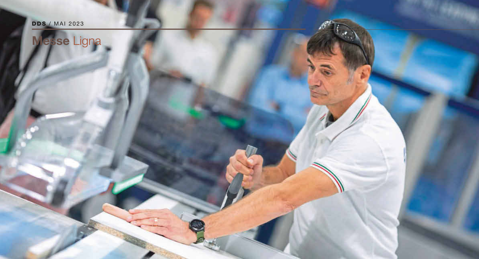
Das Sägeblatt wird die Wurst nicht verletzen, ein spezieller Sensor lässt es vorher blitzschnell abtauchen
