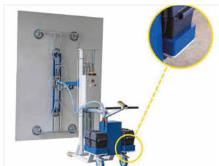
Das Untergestell mit Akku-Unterstützung dient zum Transport über Distanzen hinweg
