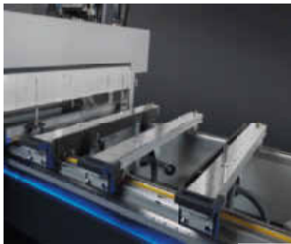
Die soliden Anschlagzylinder ermöglichen eine flexible Bauteilreferenzierung von kleinen, mittelgroßen und großen Werkstücken am Arbeitsfeld.
