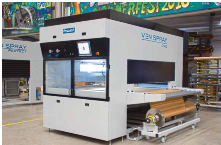
Für das Handwerk entwickelt: Spritzlackieranlage für reproduzierbare Oberflächenergebnisse in Top-Qualität – einfach von einem Mitarbeiter bedienbar
