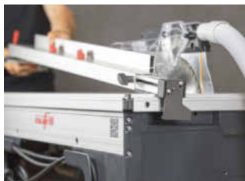
Der Parallelanschlag wird durch eine teleskopierbare Längsarretierung maßhaltig fixiert
