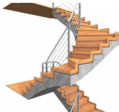
Einsatz des 3D-Scans am Beispiel einer Betontreppe
