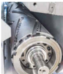
Mehr Arbeitsbreite: Die Hobelwelle in der Schleifmaschine
