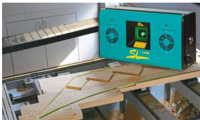
Die Laserlinie verhindert Ausschuss und Schäden an den Saugern
