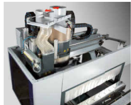
Durch die automatische Steuerung des Absaugstutzens wechselt die volle Absaugleistung immer zwischen Bohrkopf und Hauptspindel, je nachdem was gerade eingesetzt wird.
