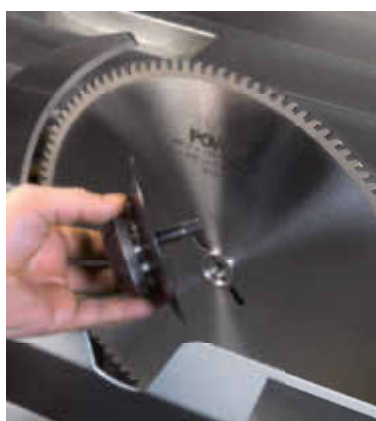
Sägeblattwechsel schnell, unkompliziert und als weltweit einziges System ohne Werkzeug
