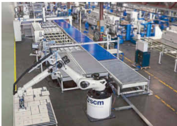
Der Roboter räumt das Nest ab und beschickt die Bekantungszelle
