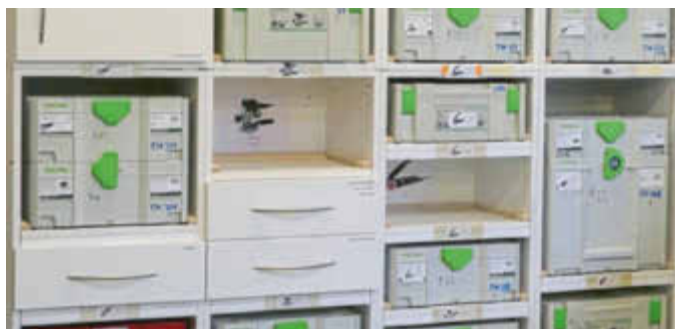
Offene oder transparente Fächer, Bilder und Beschriftungen an den Werkzeugkisten und an den Rückwänden führen zu mehr Übersicht
