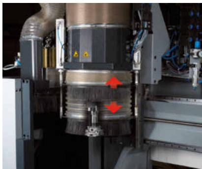
Die Absaughaube passt sich vollautomatisch mit 3 Stufen auf die jeweilige Werkstückhöhe an und reduziert so die Staub- und Geräuschbelastung erheblich.
