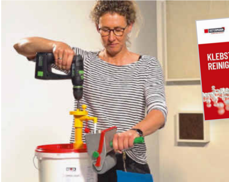
Mit der Leimpumpe Easy-Pump lassen sich Flüssigkeiten aus großen Gebinden sauber in kleinere Behälter umfüllen
