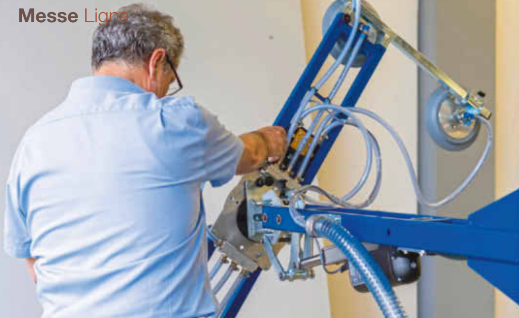
Eine Person genügt mit dem Vakuumlifter, um auch große Platten kräfteschonend zu bewegen
