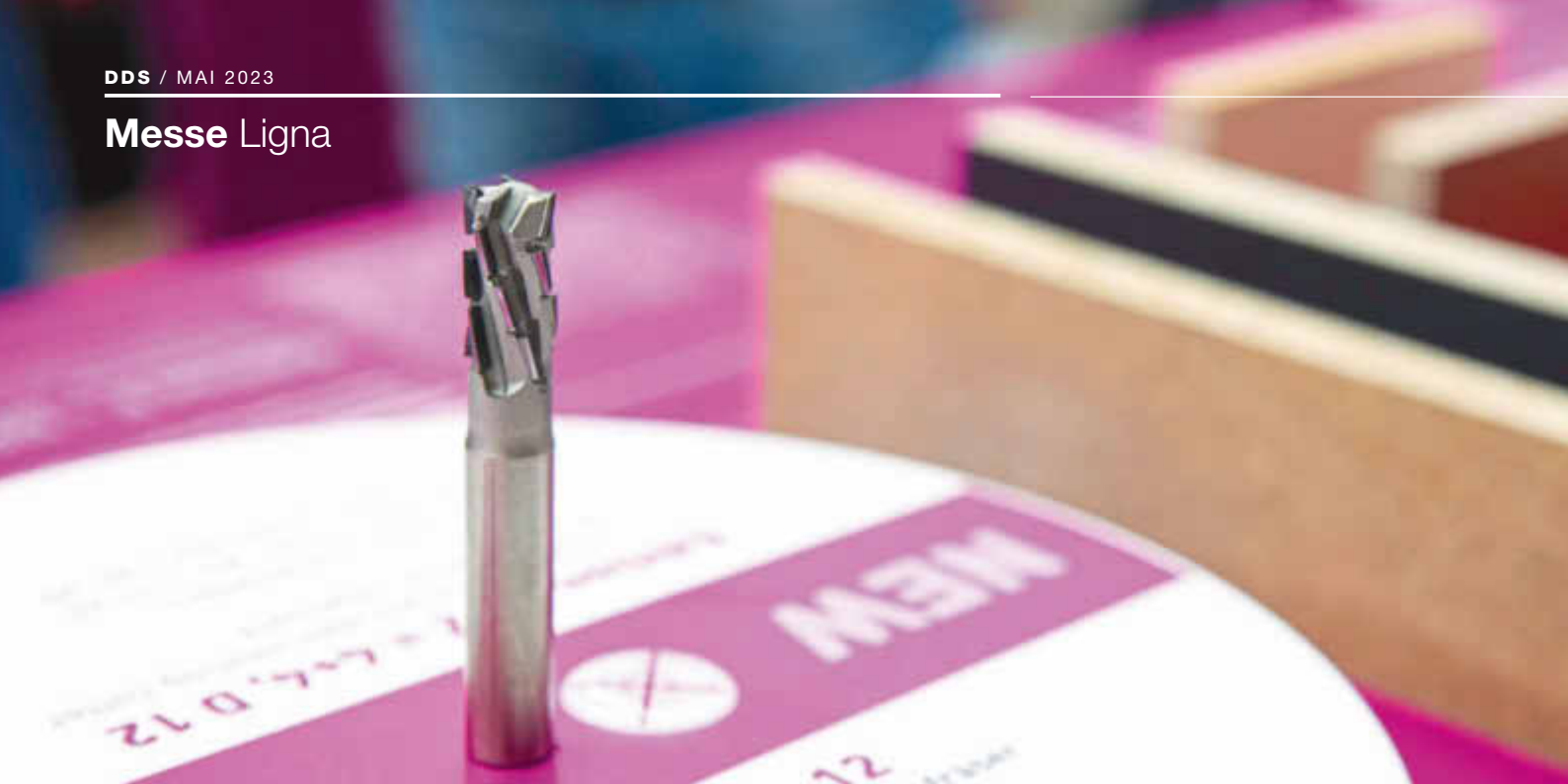
Nestingfräser Z4+4 D 12 mit Schneidenanordnung nach dem Fibonacci-Prinzip
