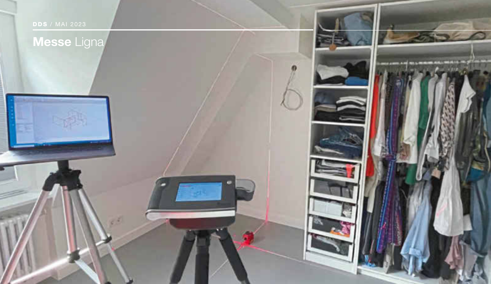
Aufnahme der Einbausituation unterhalb der Dachschräge mit dem Flexijet-3D-System
